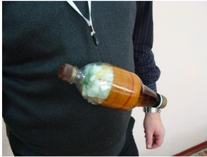
Фото 16. Варіант захисту наповнювача (фільтра) респіратора від випаровування нейтралізуючого розчину.
